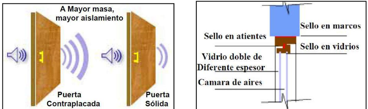
IMAGEN 79: Detalle de materiales acústicos. FUENTE: Elaboración Propia
