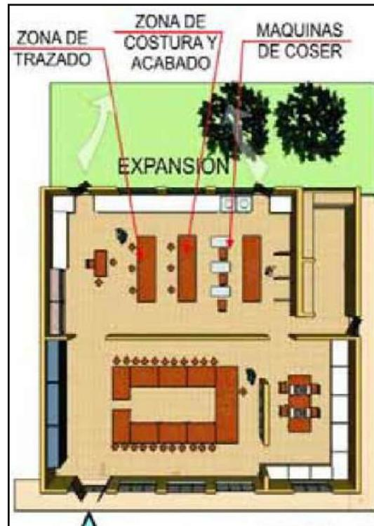
IMAGEN 53: Descripción de taller industria del vestido. FUENTE: Norma Técnica para el Diseño de las Escuelas Primaria y Secundaria (MINEDU)
