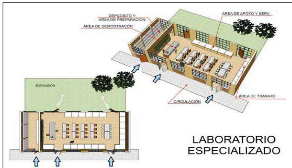
IMAGEN 54: Descripción del laboratorio. FUENTE: Norma Técnica para el Diseño de las Escuelas Primaria y Secundaria (MINEDU)
