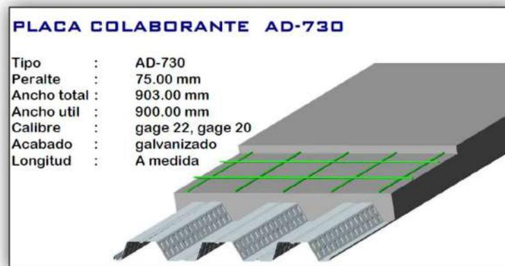
Fig. 34 Especificaciones Técnicas de Placa Colaborante
