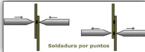
*Fig. 54 Soldadura por Puntos*
