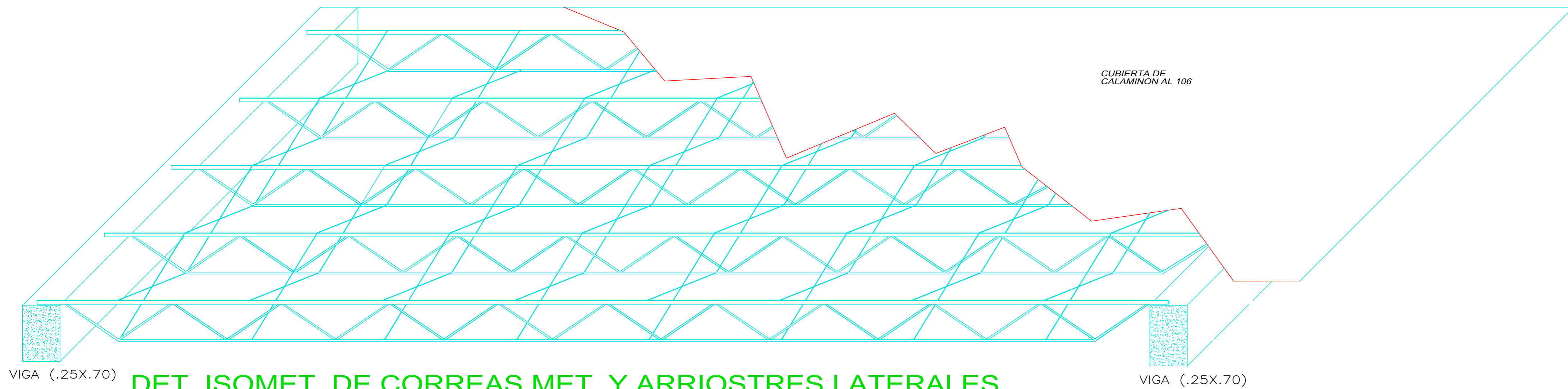
DET. ISOMET. DE CORREAS MET. Y ARRIOSTRES LATERALES
