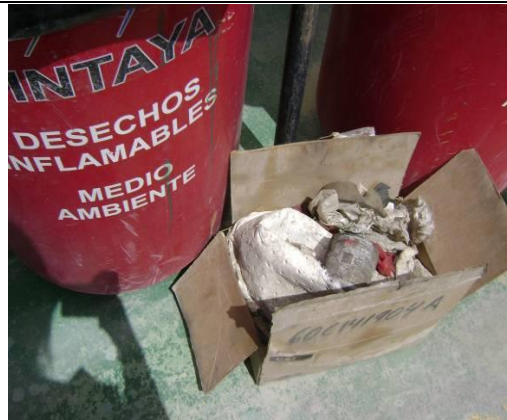
Improvisación de acopiamiento de Residuos Inflamables por falta de espacio en contenedores respectivos.
