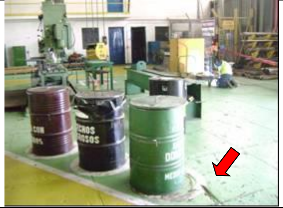
Adecuación de zonas específicas para la ubicación de los cilindros contenedores de residuos (delimitación pintada en el suelo, para evitar traslados del contenedor)
