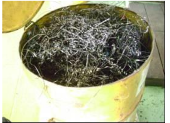
Contenedor: Residuos metálicos (AMARILLO) Encontrado: Buena segregación de residuos de acuerdo a las características (Virutas de metal)
