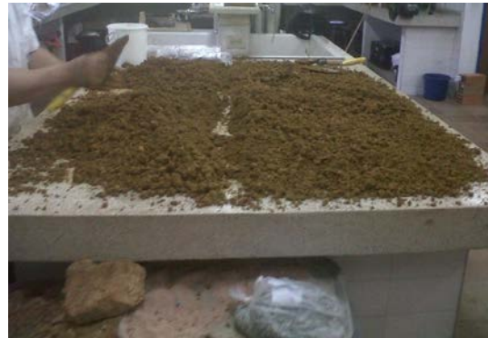
FIGURA N° 5 CUARTEO DE MUESTRA DE SUELO Y TAMIZAJE POR LAS MALLAS
