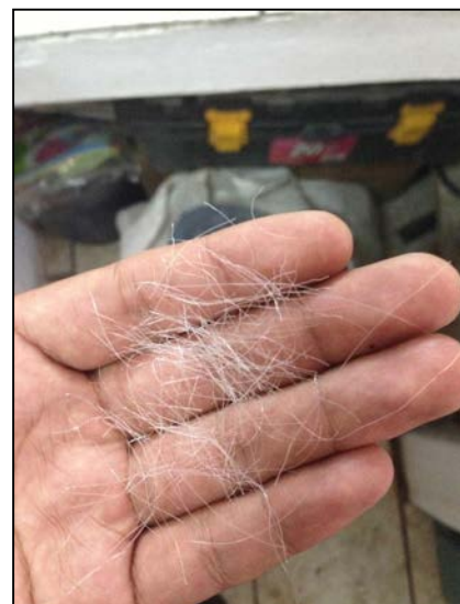
FIGURA N° 6 PESO DE LA FIBRA PARA UNA DOSIFICACIÓN DE 0.1%. Y DE LONGITUD DE 5CM
