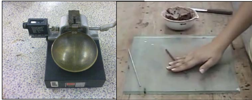
FIGURA N° 7 COPA DE CASAGRANDE Y LIMITE PLÁSTICO
