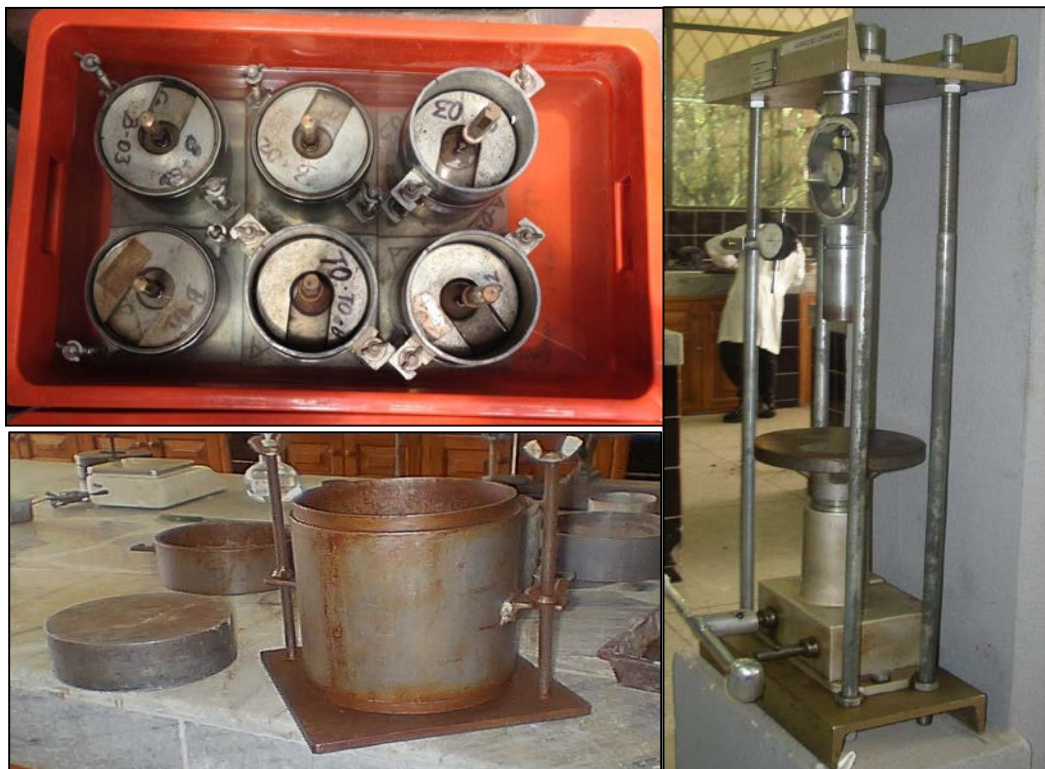
FIGURA N° 16 MOLDE CBR Y EQUIPO CBR
