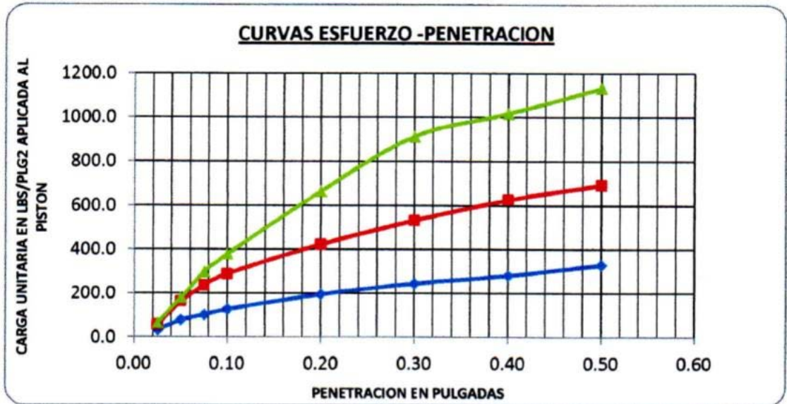
GRÁFICO N° 05 CURVA ESFUERZO PENETRACIÓN PARA 0.1% DE FIBRA
