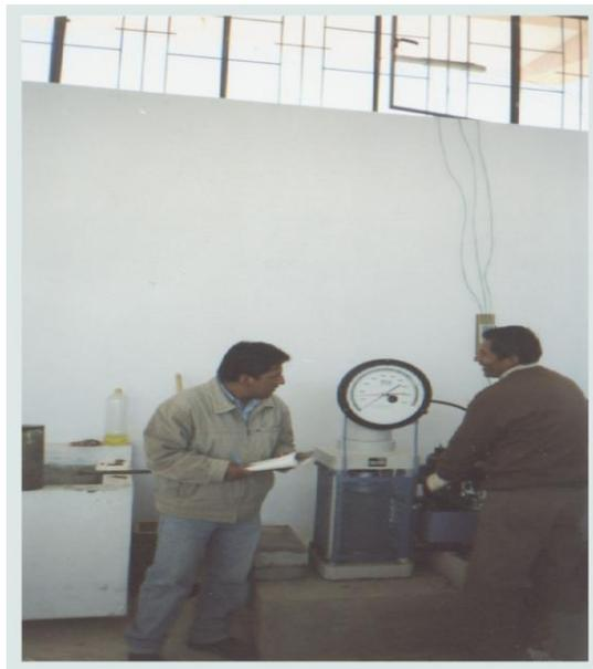
**IMAGEN N°8:** Se muestra la rotura de la briqueta y se lectura la resistencia a compresión promedio del concreto
