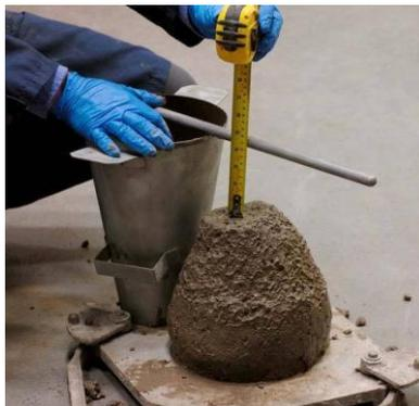
**Figura 7.** Ensayo de consistencia o Slump mediante el cono de Abrams.
