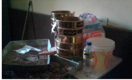
**Figura 11.** Proceso de análisis granulométrico por tamizado
