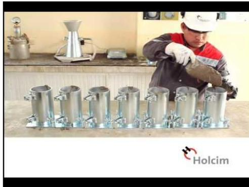
**Figura 8.** Elaboración de probetas cilíndricas de concreto Abrams
