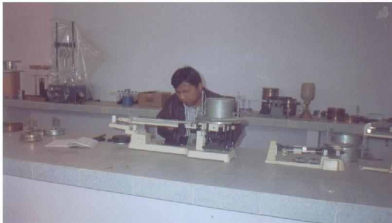
**IMAGEN N° 4:** Pesando el peso unitario compactado en la balanza. Con el respectivo molde de proctor.
