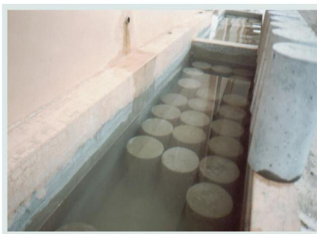
**Figura 19.** Curado de concreto en posas contenidos de agua.
