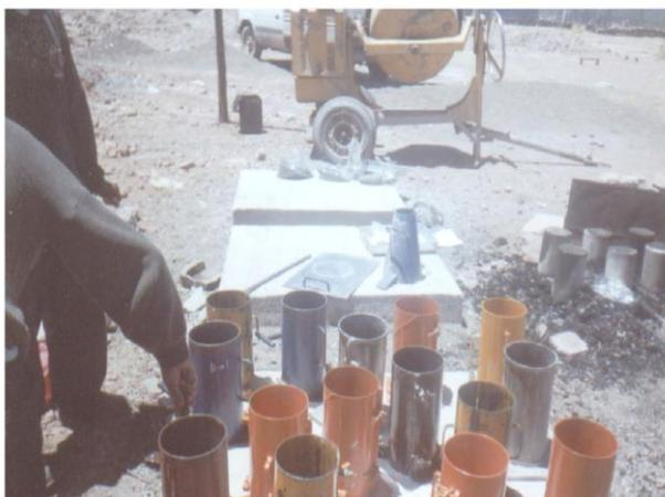
**Figura 16.** Preparación de los cilindros para el vaciado de concreto
