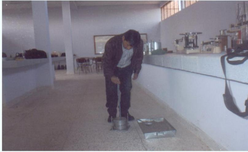
**IMAGEN N° 3:** Realizando el peso unitario compactado, a cada 25 golpes, en tres capas para obtener pesos específicos del agregado fino.
