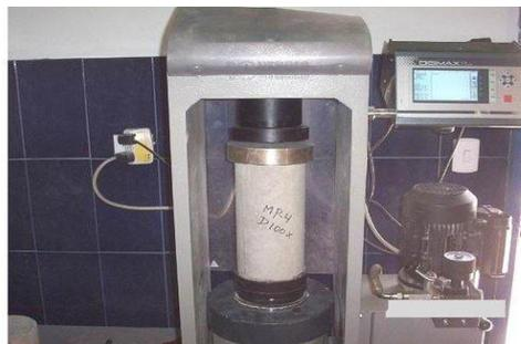
**Figura 3.** Ensayo de la Resistencia a la compresión del concreto
