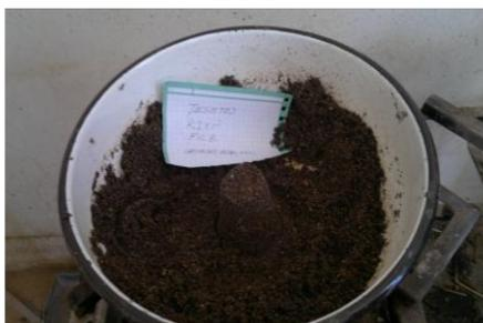
**Figura 15.** Proceso de secado de muestra de arena natural
