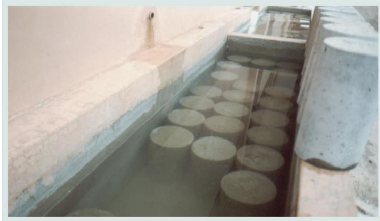
**IMAGEN N°7:** Se muestra el curado de las briquetas de concreto en poza, para luego determinar la resistencia a la compresión.
