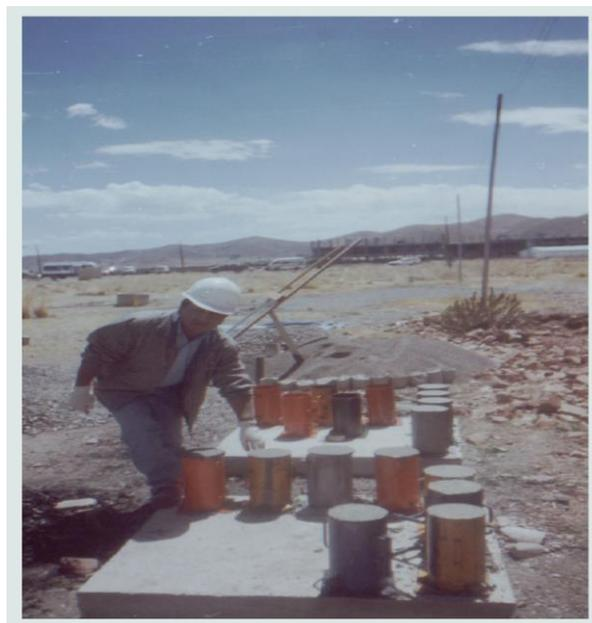
**IMAGEN N°6:** Se muestran las briquetas vaciado de concreto y enrasados
