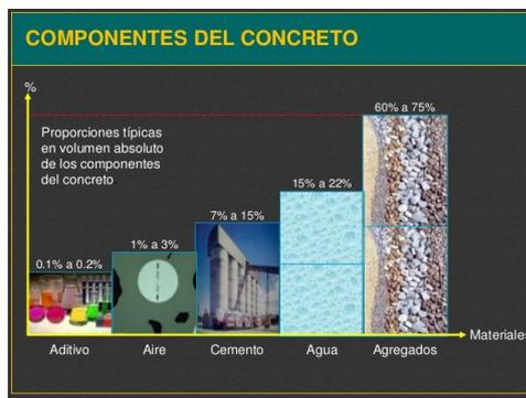
**Figura 4.** Composición típica del concreto
