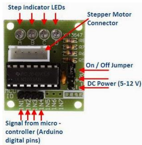
Figura 5.4. Conexiones del Driver ULN2003
