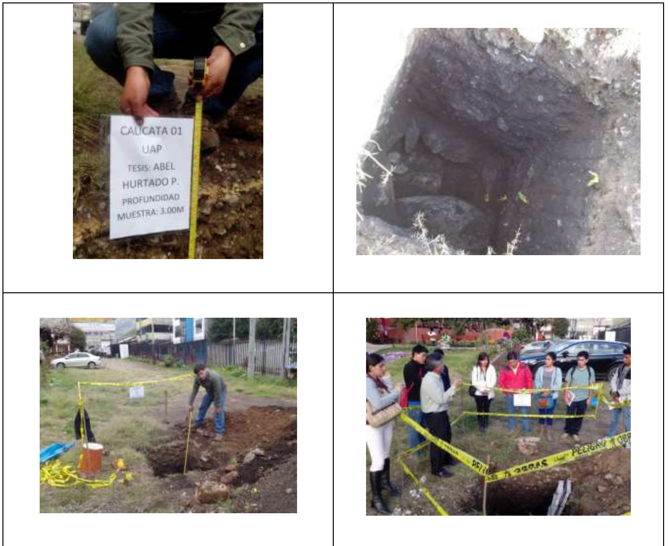
(Figura 23) Fotografías: de calicata en el patio de la ciudad universitaria Fuente: elaboración propia Apoyo ing. Oscar Morón (docente UAP)
