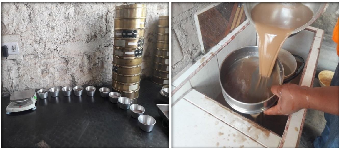
Figura 6.4. Peso de la muestra de cada tamiz y lavado de material arcilla.
