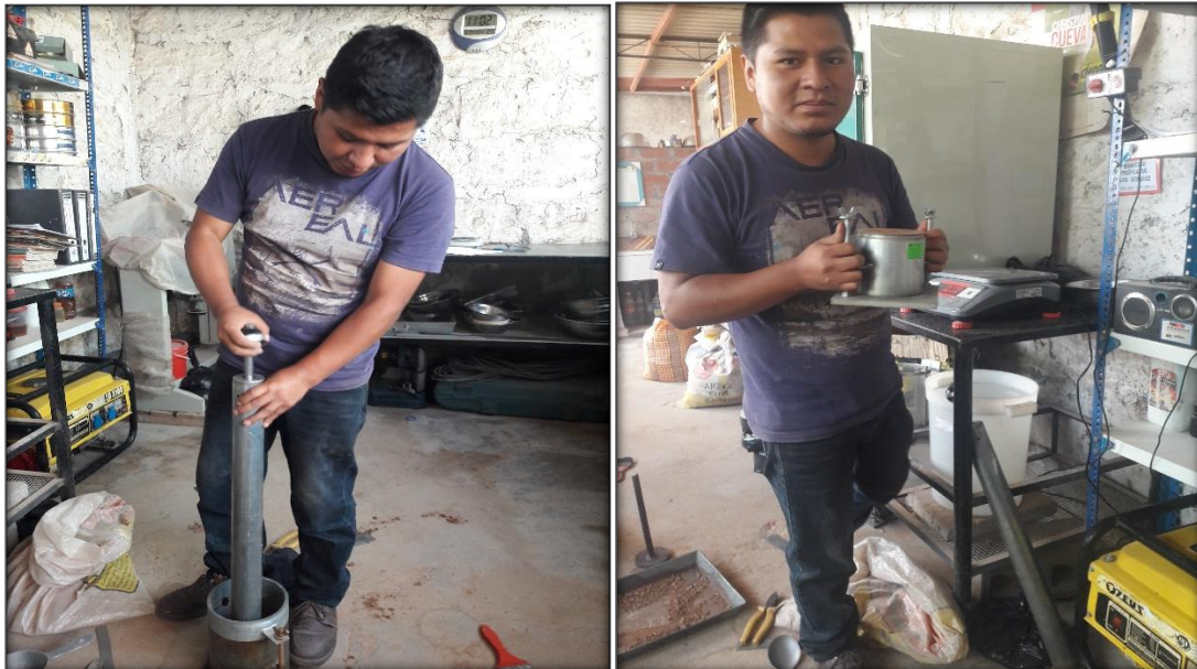
Figura 6.17. Compactación de la muestra en el molde y peso de la muestra más molde.
