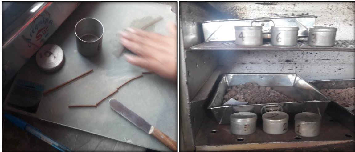
Figura 6.11. Barritas cilíndricas 3mm y cápsulas en horno a 110°C.
