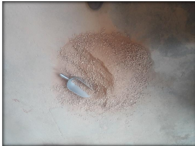
Figura 6.3. Cuarteo de la muestra.
