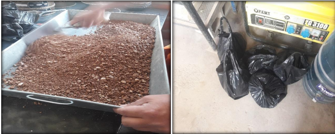
Figura 6.12. Mezclado de muestra-agua, saturado de muestra por 24 horas en bolsas.
