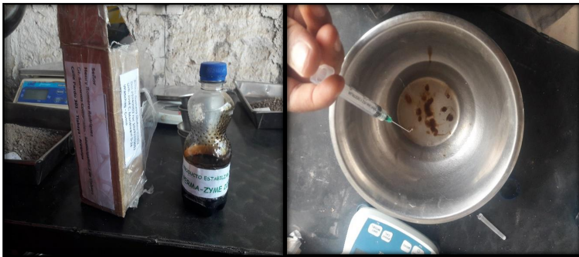
Figura 6.31. Producto estabilizante PZ-22X diluyendo en agua.
