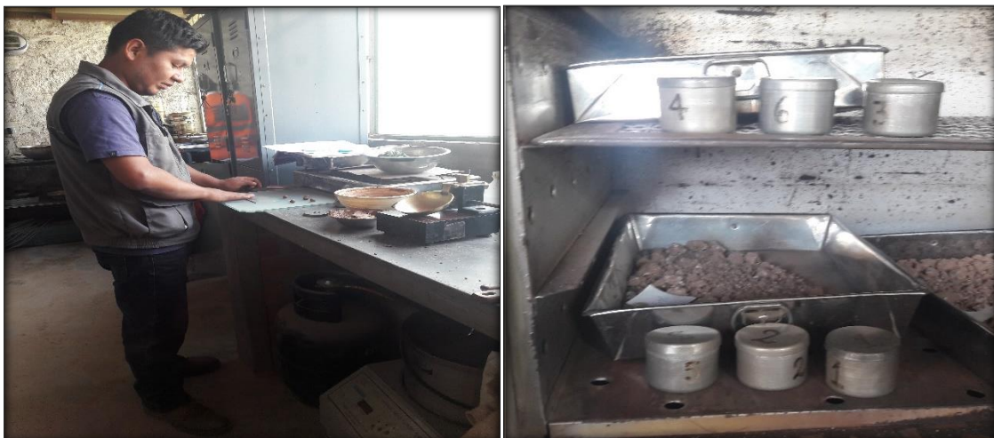
Figura 6.25. Barritas cilíndricas 3mm y cápsulas en horno a 110°C.
