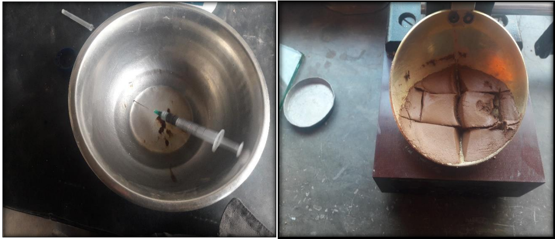
Figura 6.23. Aplicación de PZ-22X en agua y aparato Casagrande.
