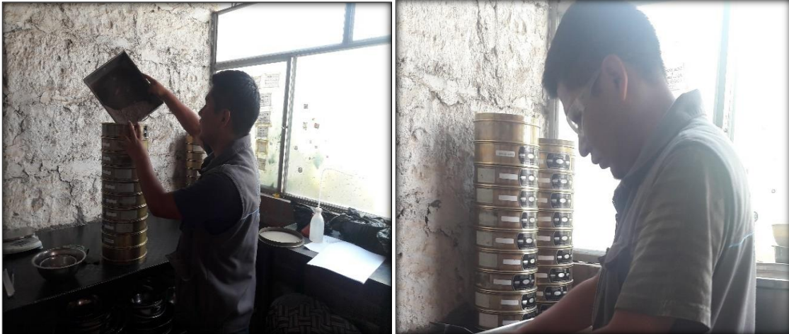
Figura 6.5. Tamizado de la muestra.
