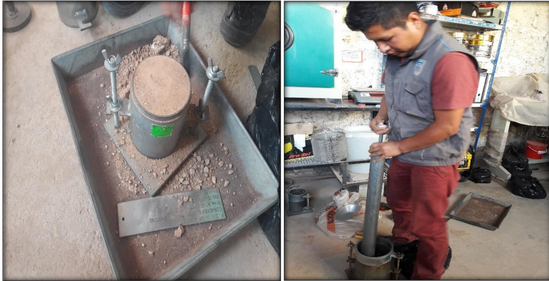
Figura 6.32. Enrazado de la muestra en molde para su compactación.
