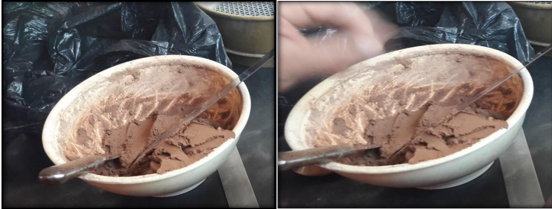
Figura 6.7. Mezcla de arcilla con agua para los ensayos L.L. y L.P.
