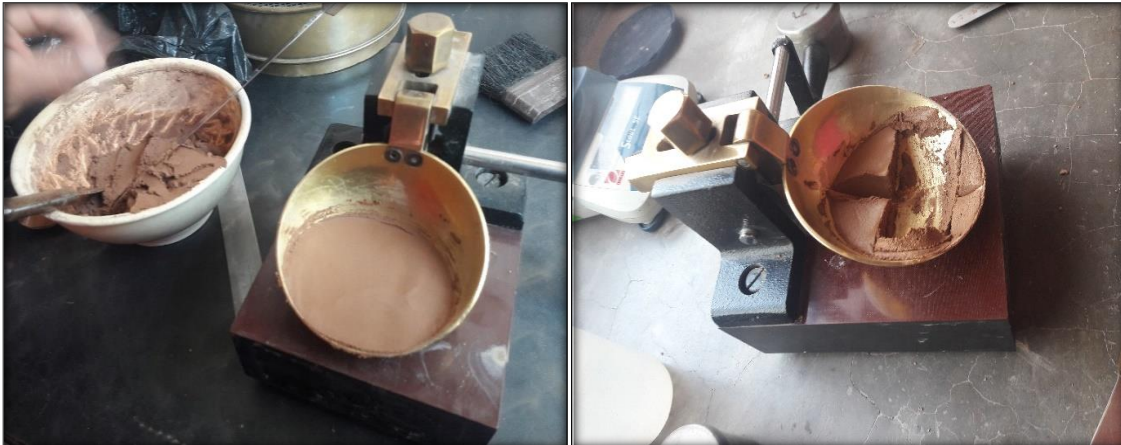
Figura 6.8. Aparato Casagrande analizando el Límite Líquido.
