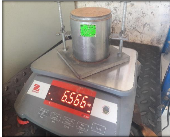
Figura 6.15. Toma de nota del material compactado.
