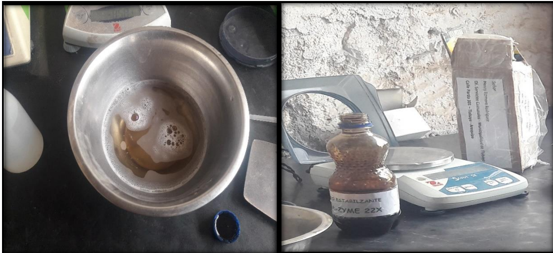
Figura 6.27. Aplicando el estabilizador PZ-22X en agua
