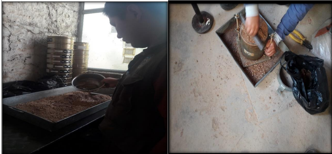
Figura 6.16. Preparación y humedecimiento para realizar el ensayo de CBR.
