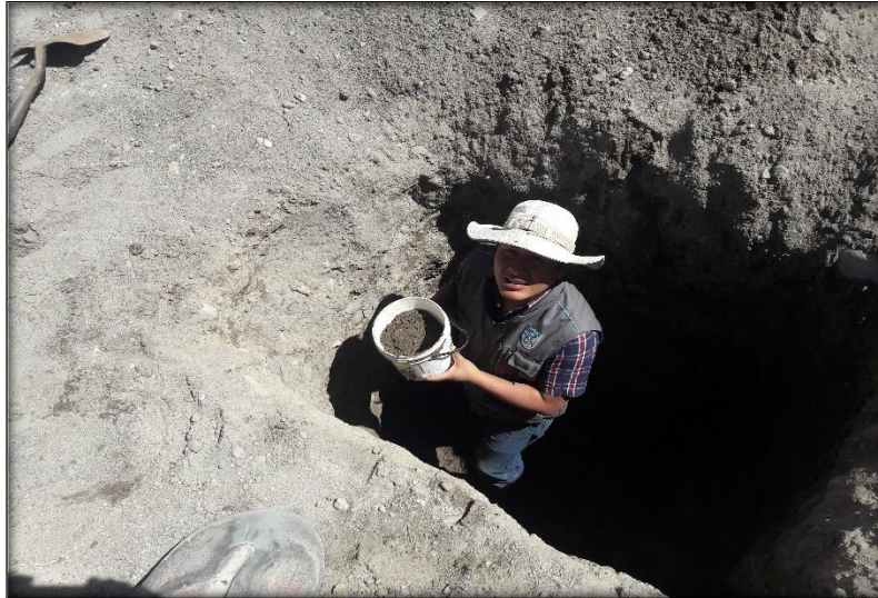
Figura 6.2. Calicata N°11 y una profundidad 1.5m.
