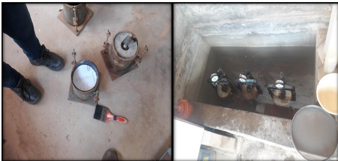
Figura 6.33. Molde de 12, 25 y 56 golpes y muestra sumergido en agua.
