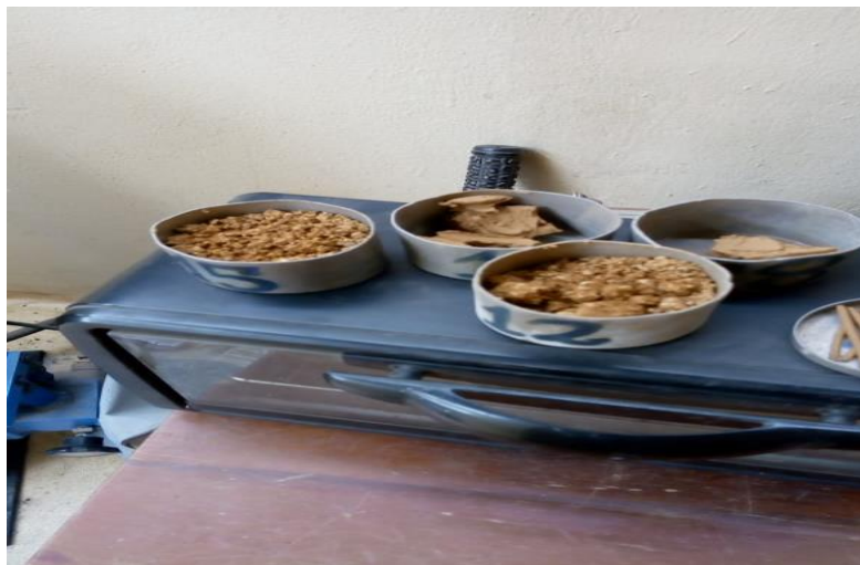
Figura 15: Secado de la muestra para contenido de humedad y densidad seca.
