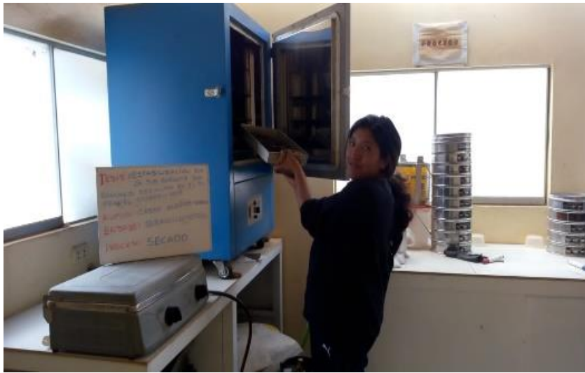
Figura 4.- Secando la muestra húmeda en el horno
