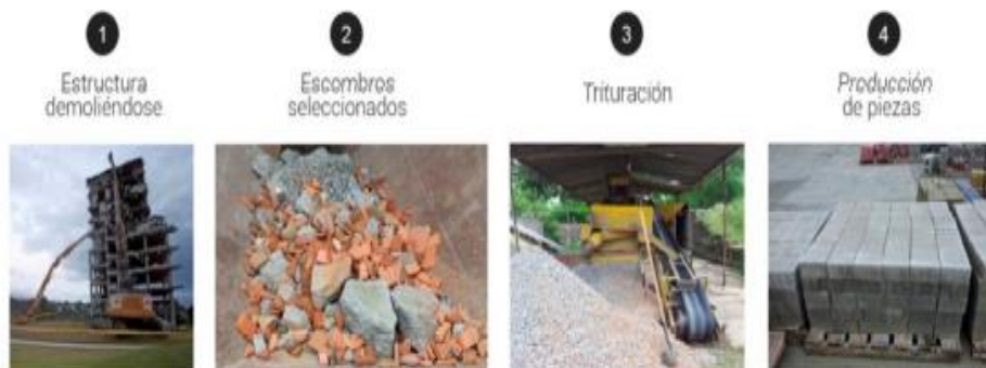
Figura 5 Proceso realizado al RCD Fuente: Valle del cauca pag.12
