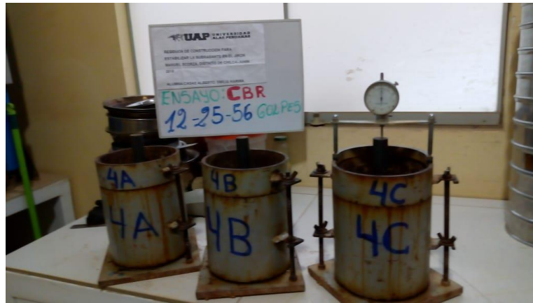
Figura 19: Extensómetro para medir la expansión
