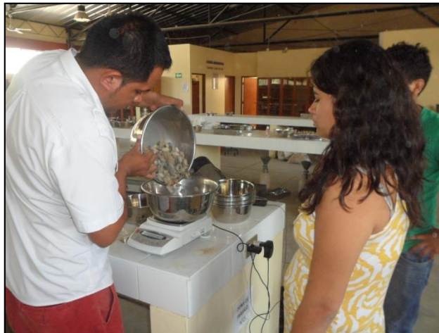
Grafico N° 21: Pesando el Agregado Grueso
