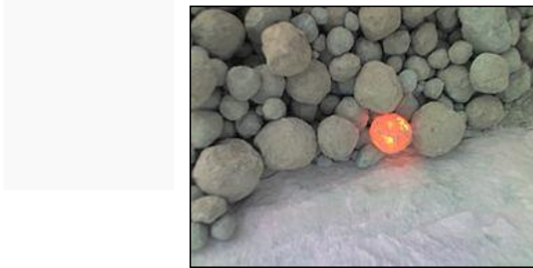
Grafico N° 03 Clinker de cemento antes de su molienda
