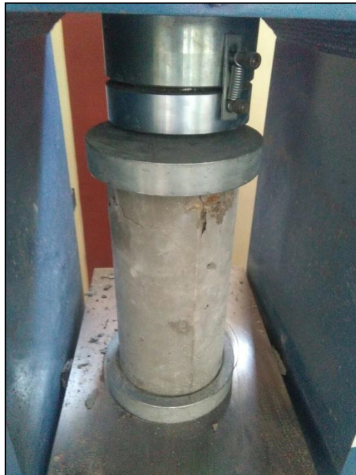
Grafico N°27: Fuerza aplicada a la probeta
