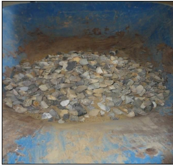
Grafico N° 20: Mezcla del Agregado Fino y Agregado Grueso segun cantidades del ensayo
