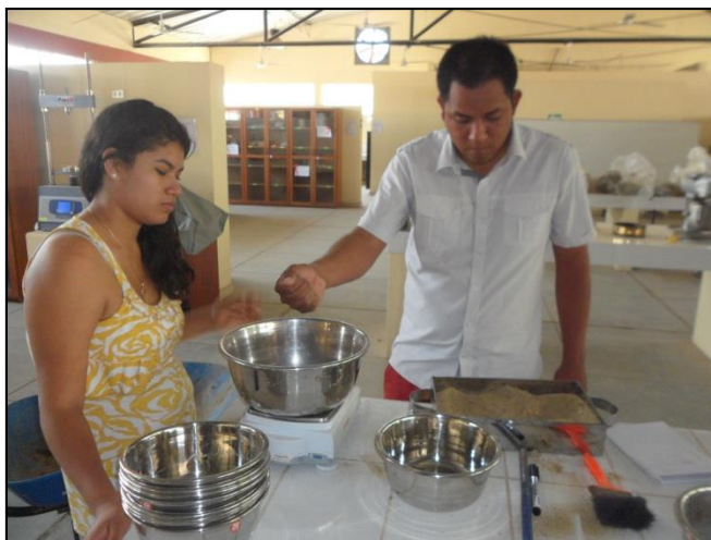
N°22: Pesando el Agregado Fino antes de lavar
