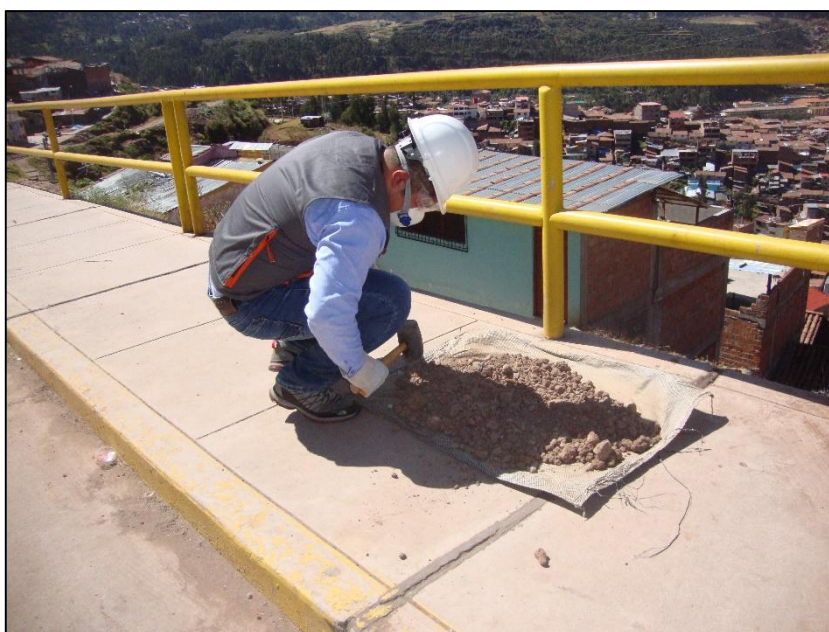
Fotografía 4: Disgregación del Material Seco con la Comba de Goma.
