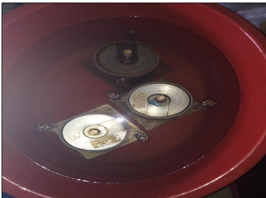
Fotografía 12: Moldes de CBR sumergidos
