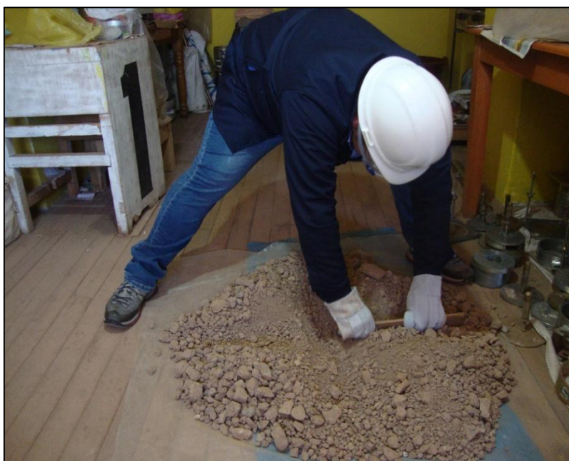
Fotografía 8: Proceso de Cuarteo del Material
