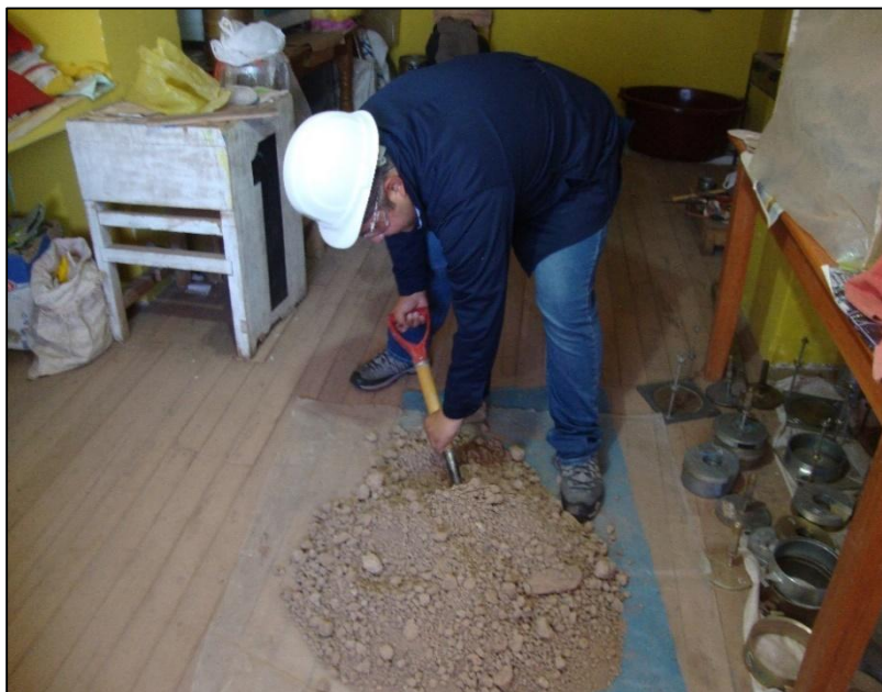
Fotografía 7: Cuarteo del Material Granular
