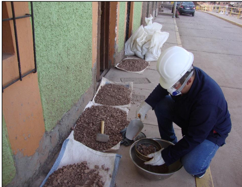
Fotografía 10: Tamizado material # N° 3/4 para ensayo de Proctor Modificado
