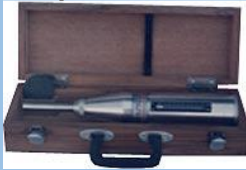
Imagen 42: Equipo de esclerómetro y la tabla de conversión de lectura.
