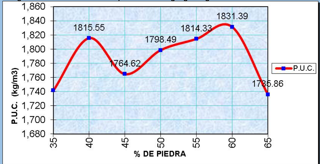
Imagen 25: Peso unitario compactado del agregado global.
