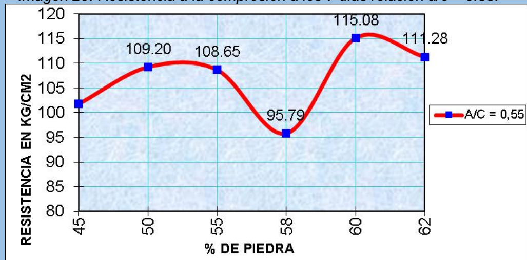
Imagen 29: Resistencia a la compresión a los 7 días relación a/c = 0.55.
