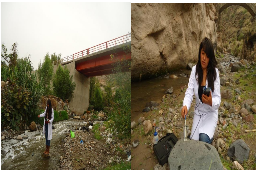
j). Registrando los parámetros fisicoquímicos del agua con el equipo multiparamétrico en la zona IV (Puente Rumichaca)
