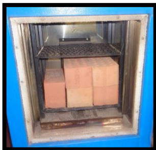
Fig. 10.1.- secado en horno a una T° de 110 °
