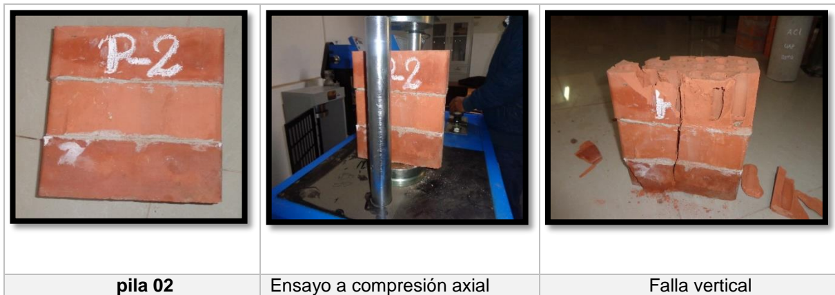
Figura 20.1: falla de las pilas 02
