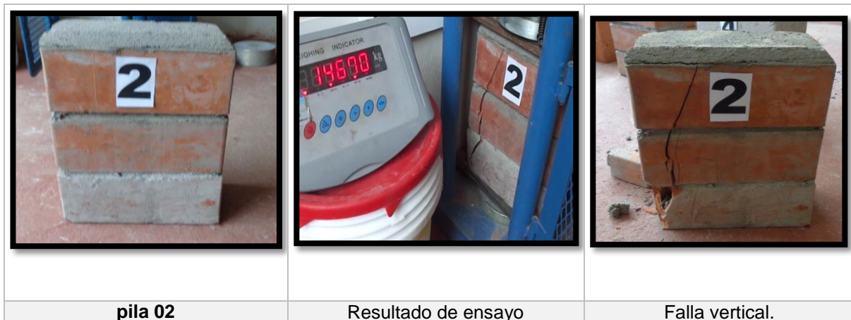
Figura 18.1: falla de las pilas 02
