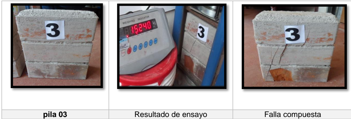
Figura 18.2: falla de las pilas 03
