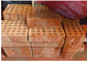
Figura 9: Materiales utilizados en los muretes y pilas
