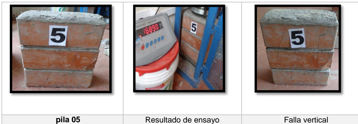
Figura 18.4: falla de las pilas 05
