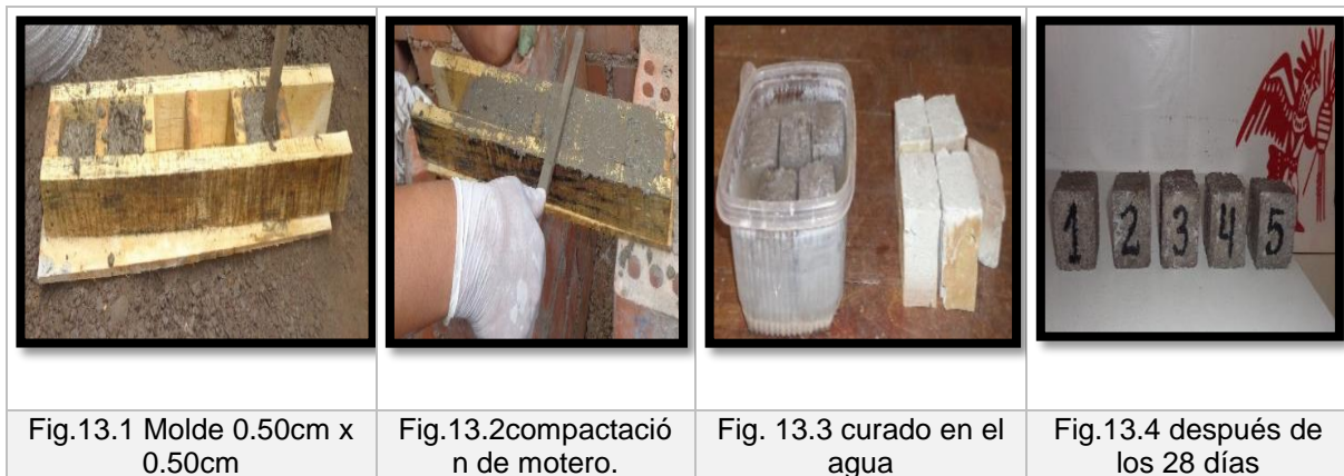
Figura 13.- compresión de cubos mortero tradicional
