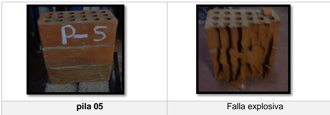
Figura 20.4: falla de las pilas 05
