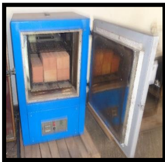
Fig. 11.1.- Ladrillos en el horno a 110 °C
