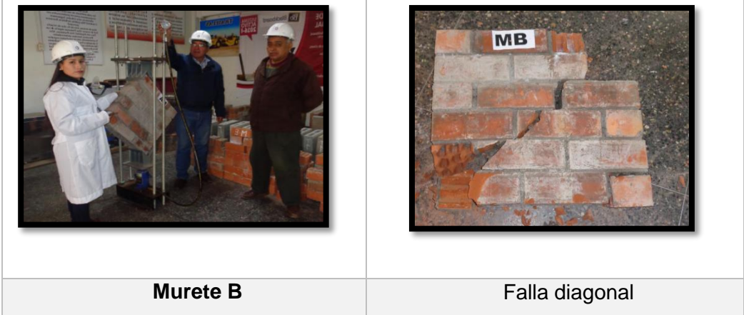
Figura 23.2: Fallas de muretes B mortero tradicional.
