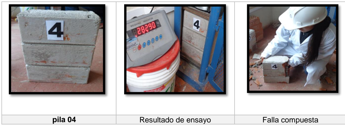
Figura 18.3: falla de las pilas 04
