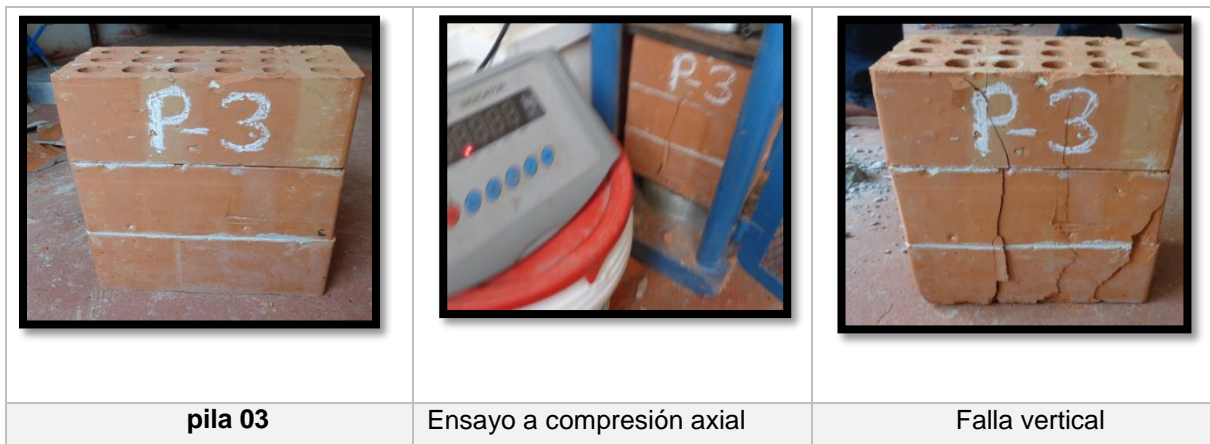
Figura 20.2: falla de las pilas 03
