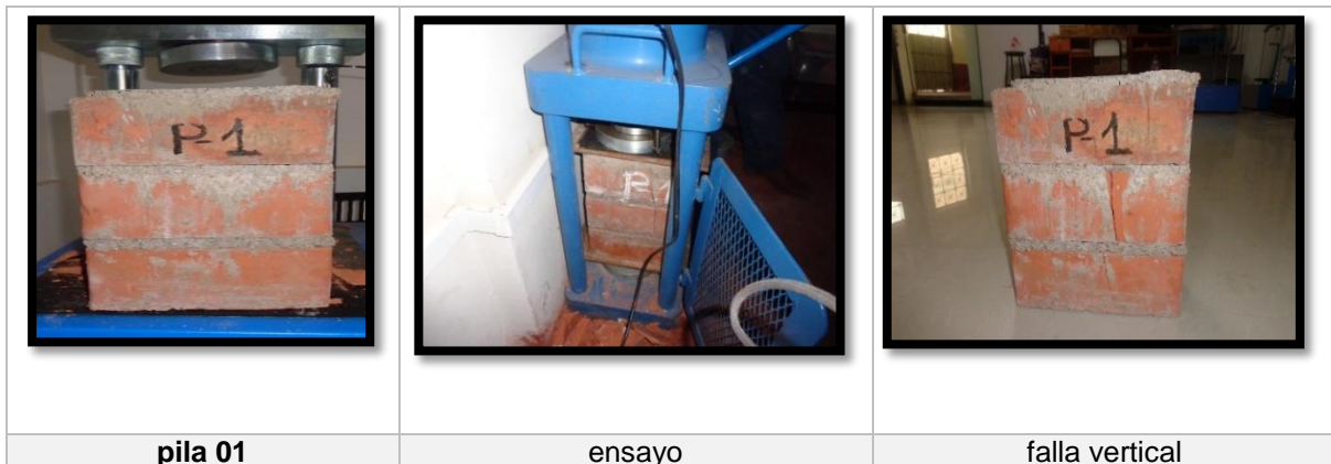
Figura 18.1: falla de las pilas 02
