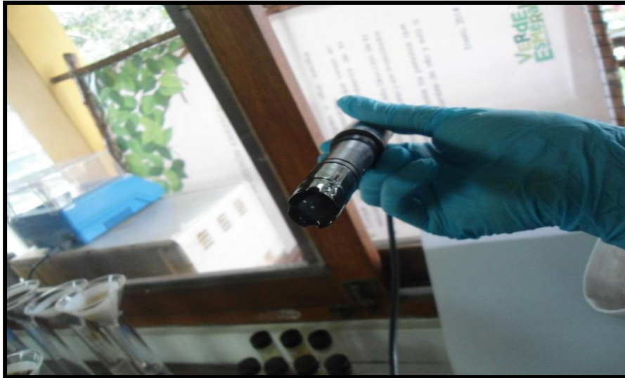
Fig. 21: Sonda polarográfica, con una cubierta protectora para membrana.
