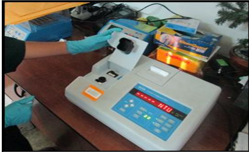
Fig. 23: Se aprecia la muestra siendo analizada en el Turbilímetro HI83414.
