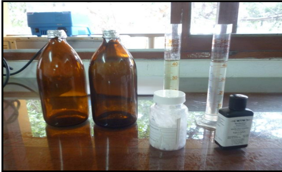
Fig. 26: Utensilios para la medición de DBO 5 , frascos Oxitop, nitrificante e imanes.
