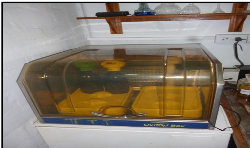
Fig. 27: Se aprecia el Oxitop Box o incubadora en pleno funcionamiento.
