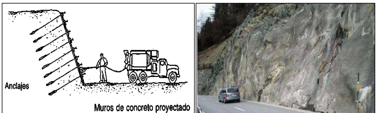
Figura 7: Shotcrete y anclajes como medidas de mitigación.
