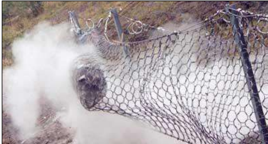
Figura 10: Barrera dinámica para mitigación de caídas de rocas.
