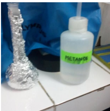
FOTO N° 17: PREPARACIÓN DE LA SOLUCIÓN DE DPPH
