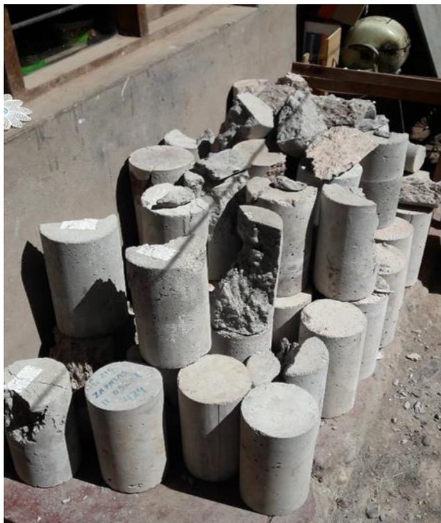
**Foto 4 Triturado de agregado reciclado de pavimento rígido y escombros de testigos de concreto**
