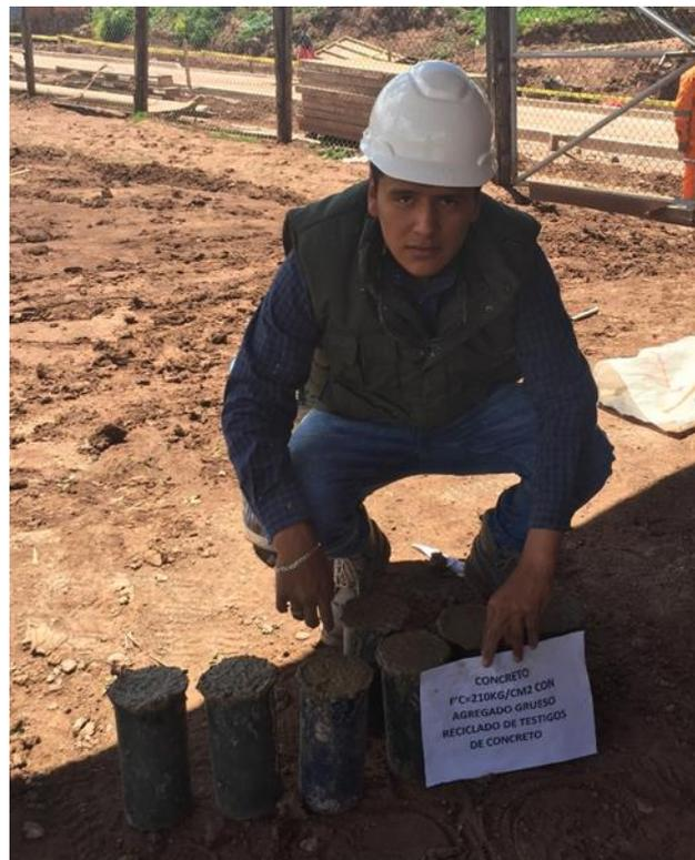
**Foto 23 Curado de testigos de concreto**
