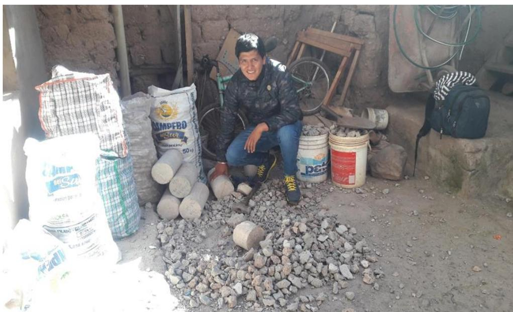
**Foto 5 Granulometría del agregado grueso de 3/4" reciclado de pavimentos rígidos y escombros de testigos de concreto**
