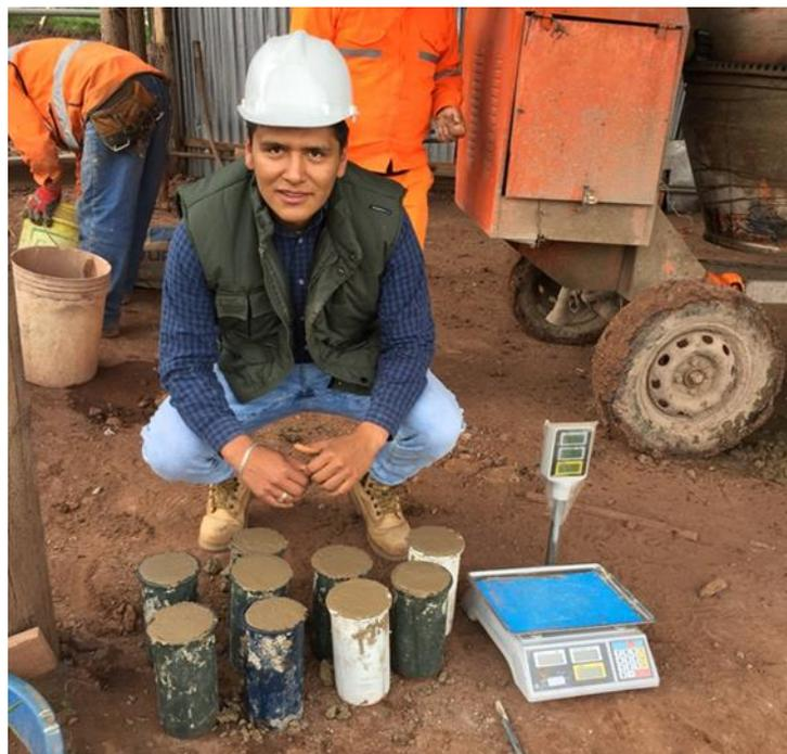
**Foto 15 Materiales para el Vaciado de Concreto  $F'C=210$  kg/cm<sup>2</sup> con agregado Grueso de 3/4" reciclado de escombros de testigos de concreto**
