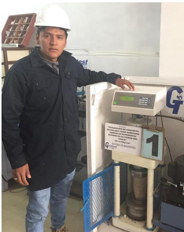
**Foto 25 Rotura de testigos de concreto**
