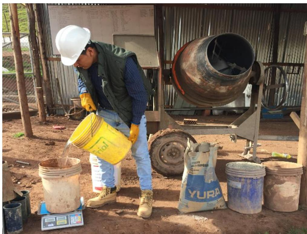
**Foto 11 Incorporación del agregado grueso reciclado de pavimento rígido**
