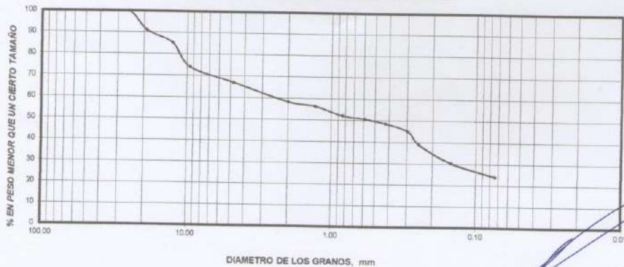
CURVA DE DISTRIBUCIÓN GRANULOMÉTRICA
