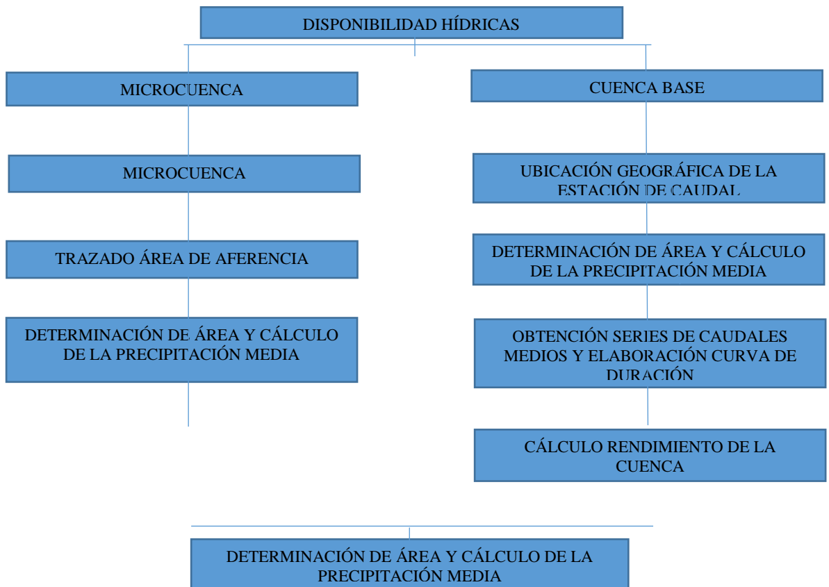
Gráfico Nº 3: Esquema metodológico_ generación de caudales en puntos de control.
