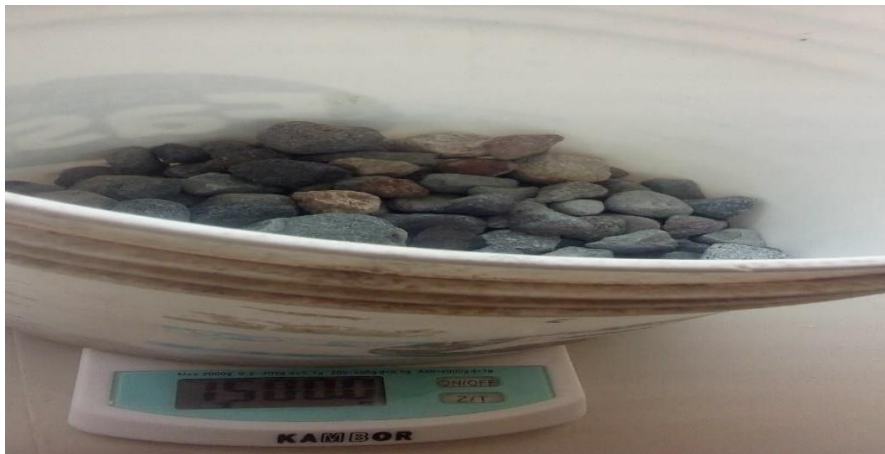
Figura 46 Peso de grava para el diseño de Humedal de flujo horizontal in vitro Fuente: Elaboración propia
