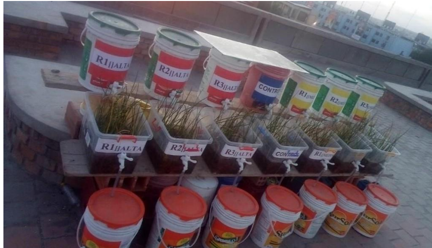
Figura 54 Diseño de humedal de flujo horizontal in-vitro Fuente: Elaboración propia
