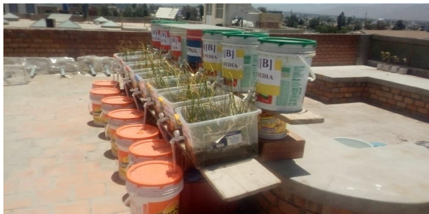
Figura 55 Diseño de humedal de flujo horizontal in- vitro Fuente: Elaboración propia
