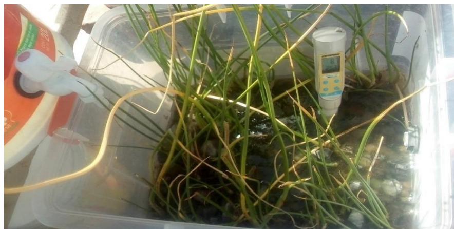
Figura 56 Medición de pH con Multiparametro (modelo PC TERST 35, marca WATERPROOF) Fuente: Elaboración propia
