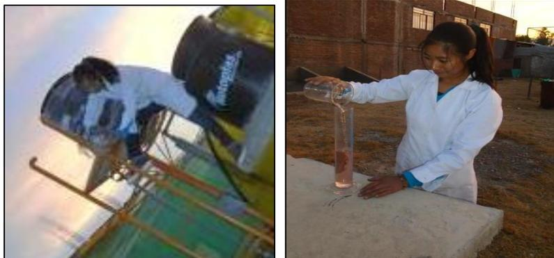
El método utilizado para determinar el caudal fue el volumétrico en el cual el caudal es igual a la velocidad del fluido sobre el tiempo.
