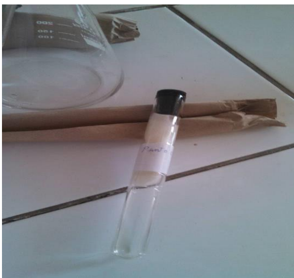
Anexo N° 17: Filtros de clorofila-a en tubos de muestreo para su conservación y transporte a laboratorio.
