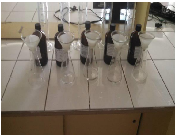
Anexo N° 17: Filtros de clorofila-a en tubos de muestreo para su conservación y transporte a laboratorio.
