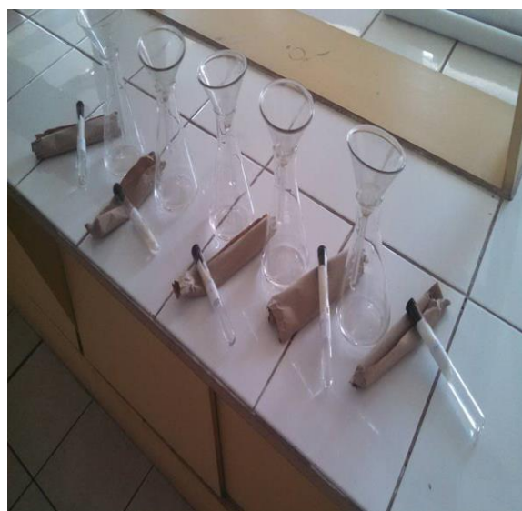
Anexo N° 17: Filtros de clorofila-a en tubos de muestreo para su conservación y transporte a laboratorio.
