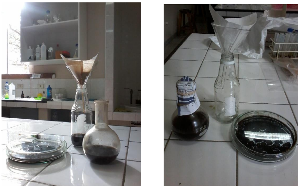
Figura 4. Después del remojo de propóleo, pasamos a filtrarlo papel filtro whatman número 40 para dejarlo sin pulpa resinosa y posteriormente dejarlo en estufa a 50° para la evaporación del etanol y dejarnos solo el propóleo.
