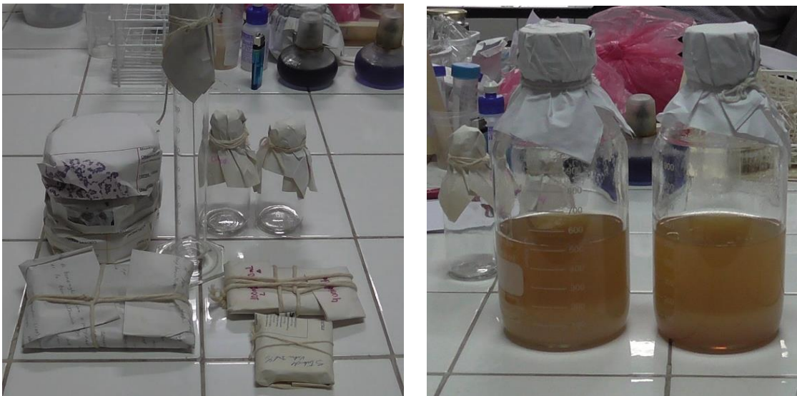
Figura 7. Preparación de Agar Sabouraut glucosado para hacer el sembrado de Candida albicans y esterilización de los materiales a utilizar
