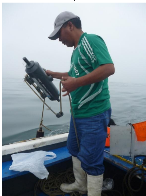
Foto N°4. Lanzamiento de botella Niskin-muestras de fondo Caleta Carquín Dic-2017
