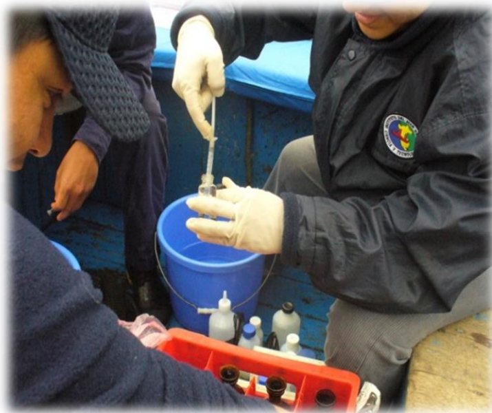
Foto N°3 Preservación de muestras para Oxígeno disuelto- Caleta Carquín Dic-2017
