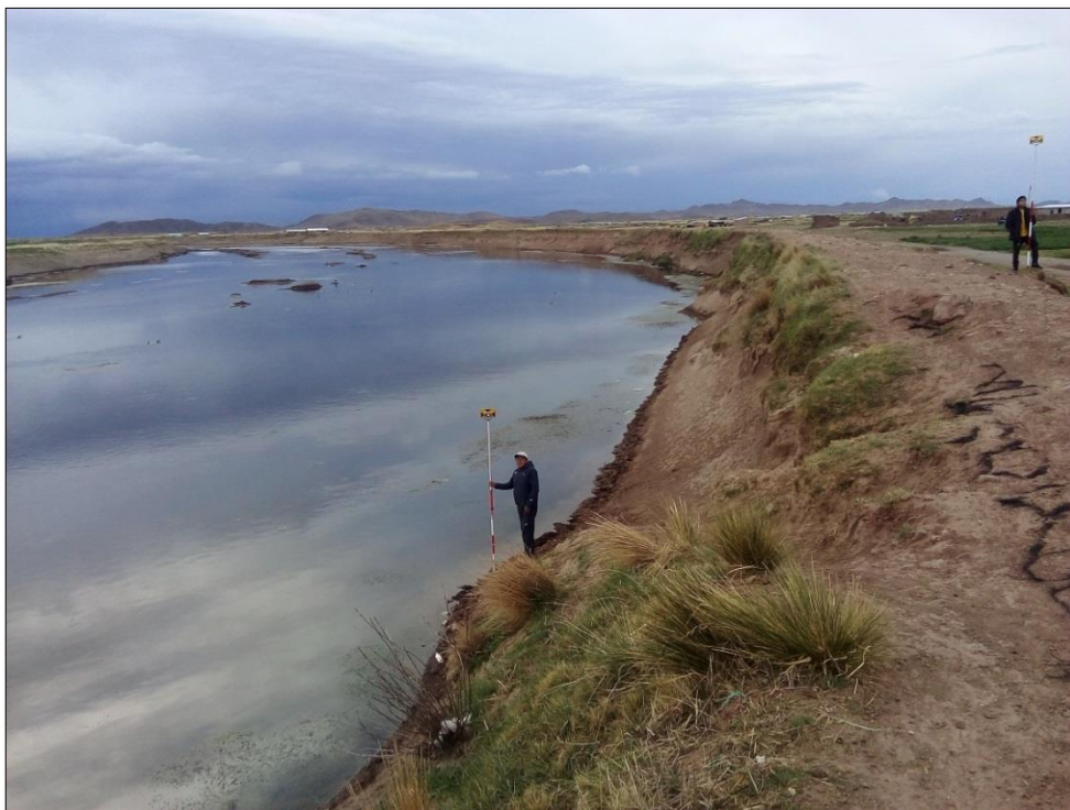
Fotografía 4. Se aprecia el colocado de prisma en el borde del agua para determinar la pendiente del flujo de agua.
