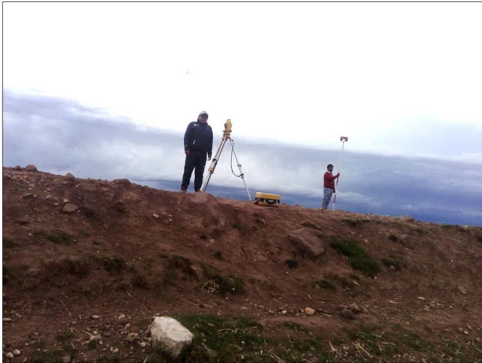
Fotografía 3. Se aprecia el levantamiento topográfico con estación total.
